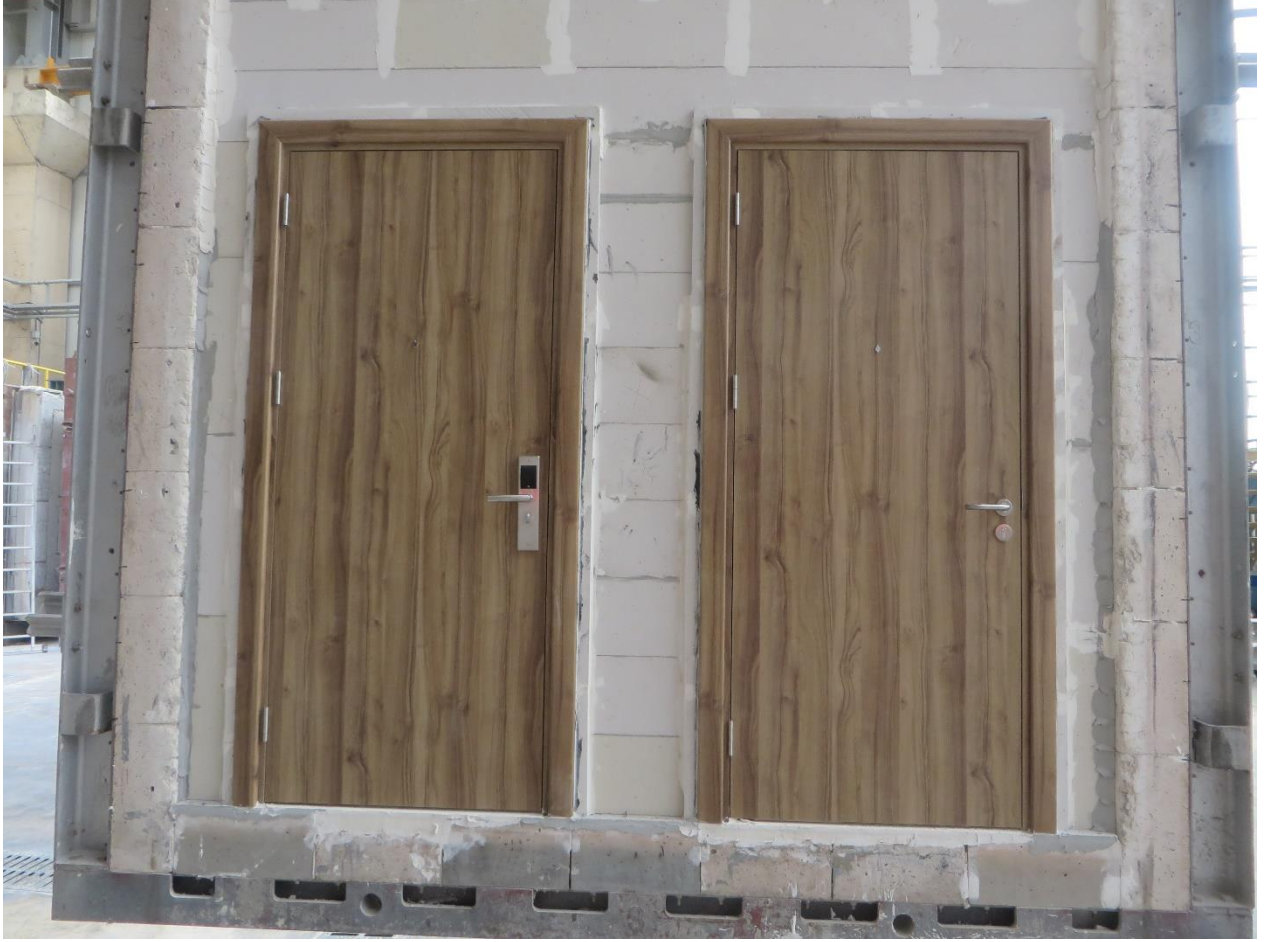
Resim C2: Kapı No.1 ve Kapı No.2'nin aleve maruz kalan yüzeyinin test öncesi görünümü.
